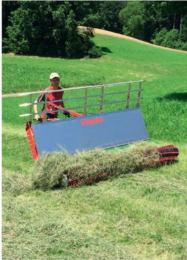
Der Rapid Multi-Twister verfügt über ein Förderband, mit dem das Erntegut nach der Aufnahme durch den bewährten Pick-up aktiv zur Seite abtransportiert wird. Daher sind Einsätze am Hang und in der Ebene möglich. Darüber hinaus vergrößert der aktive Abtransport das Einsatzspektrum hinsichtlich Grünfutter und Silage. Ebenso ermöglicht das Förderband verfahrenstechnisch den Arbeitsgang «Schwaden».
