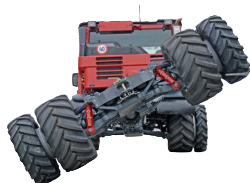
Hinterwagen in extremer Verdrehung zur Kabine (max. \pm 30^\circ )
