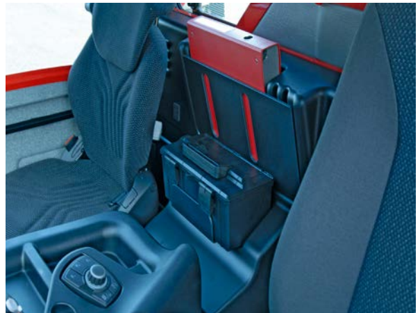
Praktische Ordnerhaltung, Werkzeugbox und hinter der Abdeckung integrierte Batterie und Bordelektrik
