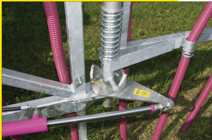
Das bewährte KOHLI - GELENK dient auch als Anfahr-sicherung (Innovationsbeispiel).
