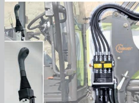
Zuverlässiges Steuergerät, das über einen mechanischen Joystick betätigt wird, der alle Funktionen in einem Griff vereint.
