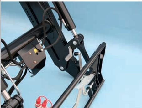
Automatische Verriegelung beim Ankuppeln des Arbeitsgerätes; ergonomischer Handgriff, optimal positioniert
