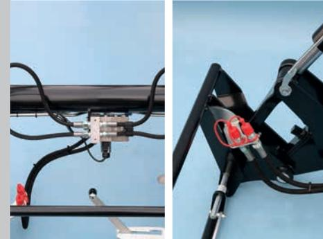
3. und 4. Funktion für den Einsatz von Greifern oder Niederhaltern; Kupplungsstecker leicht zugänglich montiert; auch mit Synchro-Lock 2-fach lieferbar
