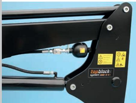
Für Transportarbeiten in unebenem Gelände; schont Frontlader, Traktor und erhöht den Komfort für den Fahrer; mechanisch zu- / abschaltbar
