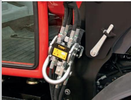
Sämtliche hydraulische (und elektrische) Anschlüsse schnell und in einem Arbeitsgang kuppeln; unter Druck kuppelbar; keine Leckagen; kein Vertauschen der Anschlüsse
