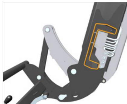
Durch die Gestaltung des Schwingenprofils und des doppelwandigen Querträgers wurde eine verwindungssteife Konstruktion geschaffen, die sich für härteste Einsatzbedingungen eignet.
