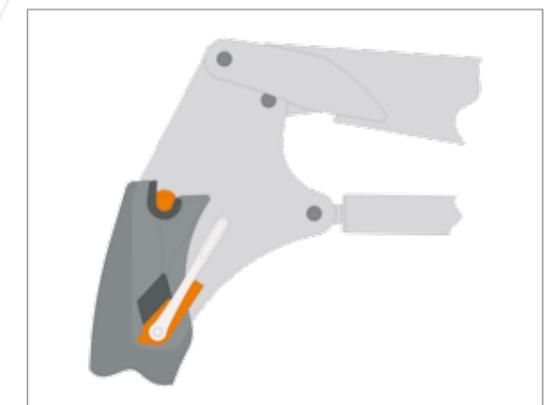
Das „TOP-BLOCK-KII“ wird als optionale Ausrüstung zum Top-Block-System angeboten. Dieses Kuppelsystem verriegelt beim Ankuppeln automatisch.
