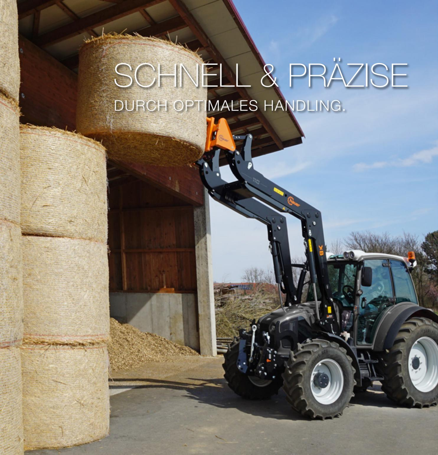
Die perfekt angepasste Anbaukonsole ist Voraussetzung für die bestmögliche Übertragung der Traktorleistung auf den Frontlader. Zusammen mit dem Frontlader ist die Konsole entscheidend für das optimale Handling beim Laden.
