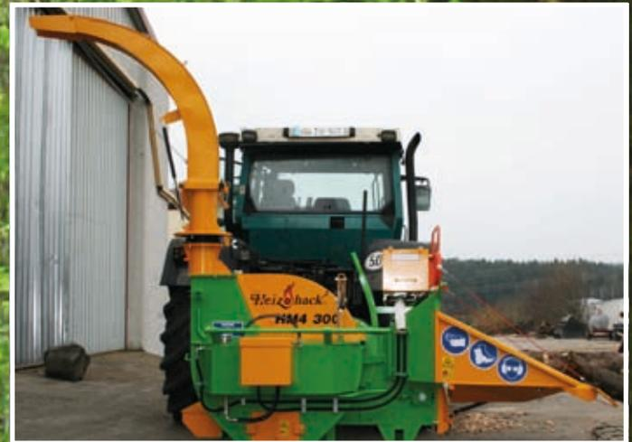
Die handbeschickten Holzhackmaschinen zum mobilen, flexiblen Einsatz vor Ort. Transportiert wird der Hacker auf einer Nachlaufachse bzw. der Dreipunktanhangung des Schleppers.
