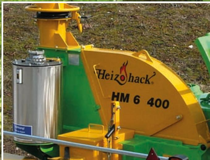
Ein großes Wurfgebläse mit integriertem Schwungrad sorgt für einen guten Auswurf der Hackschnitzel und einen kräftigen, gleichmäßigen Durchzug der Hacktrommel.
