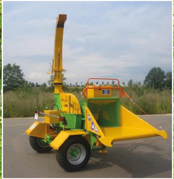
Die HEIZOHACK - Einzugssteuerung HE 002 regelt den Vorschub des zu hackenden Holzes abhängig von der Antriebsleistung. Der integrierte Betriebsstundenzähler speichert die Tages- und Gesamtstunden. Programmierbar ist auch ein kurzzeitiges Rückfahren des Stammes zur Freihaltung der Trommel.
