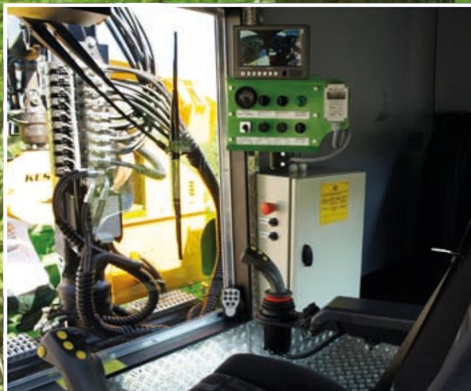
Alle Funktionen der Hackmaschine und des Ladekrans können bequem und sicher von der LKW-Kabine aus bedient werden.
