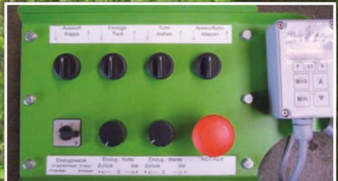
Die leistungsstarken Profimaschinen sind für Kranbeschickung serienmäßig mit ferngesteuerten Funktionen wie Turm drehen, heben und senken, Einzugsstisch heben und senken, stufenlose Einzugsregelung über Servohydraulik, elektronische Drehzahl- und Maschinensteuerung ausgestattet.
