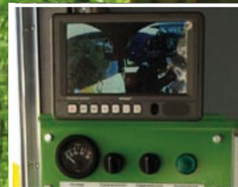
Durch eine am Auswurf montierte Kamera hat der Maschinenführer Hackschnitzel und Befüllung der Container immer sicher im Blick.
