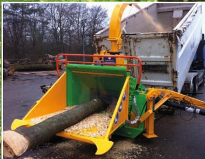
Durch wechselbare Siebe, die in verschiedenen Lochgrößen zu Verfügung stehen, werden gleichmäßige Hackschnitzel erzeugt.
