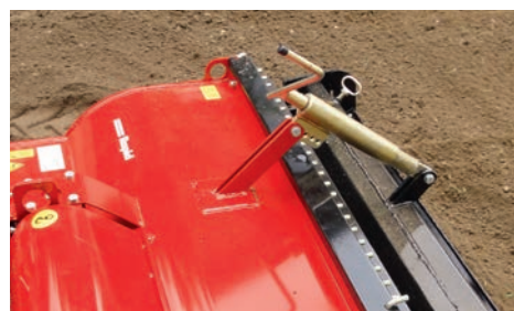
Mittels Spindel stufenlos einstellbare Bearbeitungstiefe
