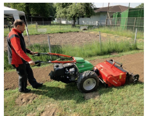
In einem Arbeitsgang Altrasen einfräsen
