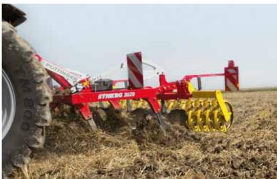
**Die zweibalkigen Grubber in kurzer Bauweise sind leichtzügig und für Traktoren mit weniger Hubkraft oder geringerem Eigengewicht bestens geeignet.**
