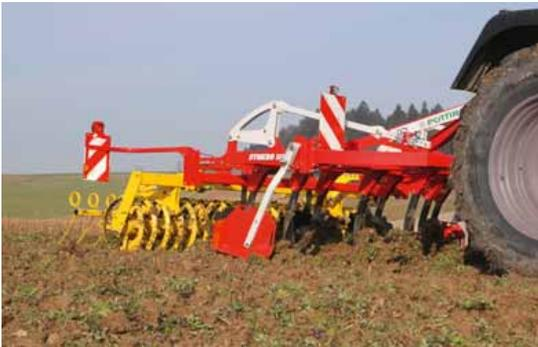
Die dreibalkigen SYNKRO 1030 Grubber eignen sich ideal für flache und tiefe Stoppelbearbeitung mit Traktoren ab 100 PS. Sie bieten technische Lösungen für noch effizienteres Arbeiten und mehr Einstellkomfort.
