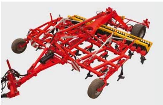
**Das Transportfahrwerk sorgt dafür, dass Hubwerk und Hinterachse des Traktors nicht überbelastet werden. Das Fahrwerk ist breit gestellt mit niedrigem Schwerpunkt, für hohe Fahrstabilität. Es kann für den Straßentransport abgesenkt werden. Die automatische Endlagen-Verriegelung trägt ebenfalls zur Transportsicherheit bei.**
