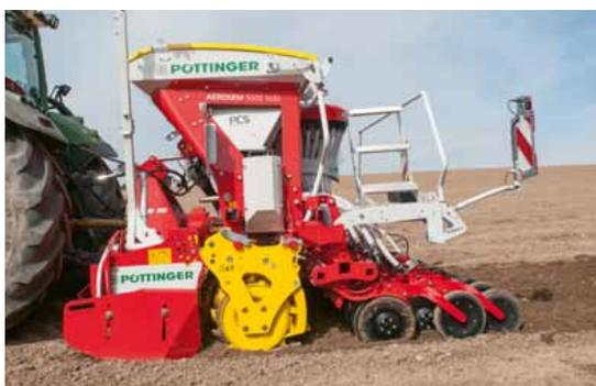
Mit der LION Baureihe 103 bietet PÖTTINGER Modelle für Traktoren bis 200 PS. Die LION 103 Ausführung steht in den Arbeitsbreiten 3 m, 3,50 m und 4,0 m zur Verfügung.
