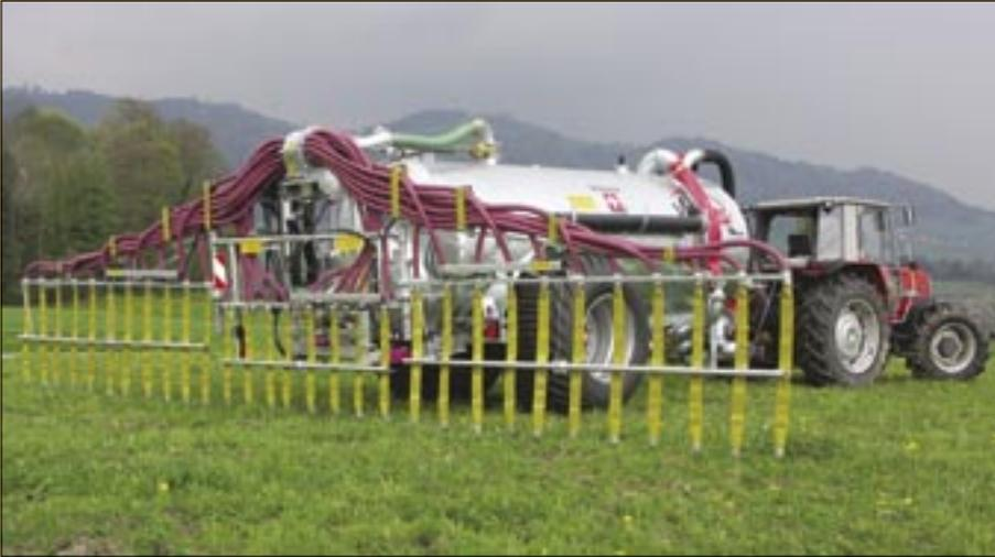
Der Standardverteiler innerhalb der Powerpack - Reihe. Erhältlich ist er in Arbeitsbreiten von 7m, 9m und 12m. Eingesetzt wird er bei mittleren bis grösseren Fässern. Verstopfungsfreie, hydraulisch angetriebene Verteilerköpfe von VOGELSANG, hydraulisch klappbare Verteilerarme, Höhenverstellung, Roll - Stop sowie elektrohydraulische Steuergeräte charakterisieren die Powerpack-Reihe.
