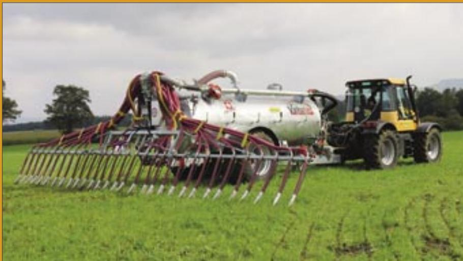
Die neuste Kohli Entwicklung bei den Fass-Verteilern ist der Starrpack. Das Gerät kann durch die automatische Klappung schnell von Transport- in Ausbringstellung gebracht werden. Die kompakte Konstruktion kann an alle Fasstypen angebaut werden. Der Starrpack kann mit gefederten Gleitschuhen ausgestattet werden. Die Gülle wird unterhalb der Blätter auf den Boden abgelegt, wodurch die Blattverschmutzung vermieden wird. Der Verteiler arbeitet hervorragend auf Gras, Getreide oder Ackerboden.
