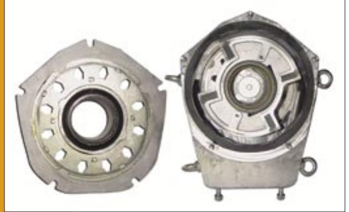
Selbstnachstellende Messer, auswechselbare Schneiden mit verschiedenen Lochgrößen, für Druckfass oder Verschlauchung
