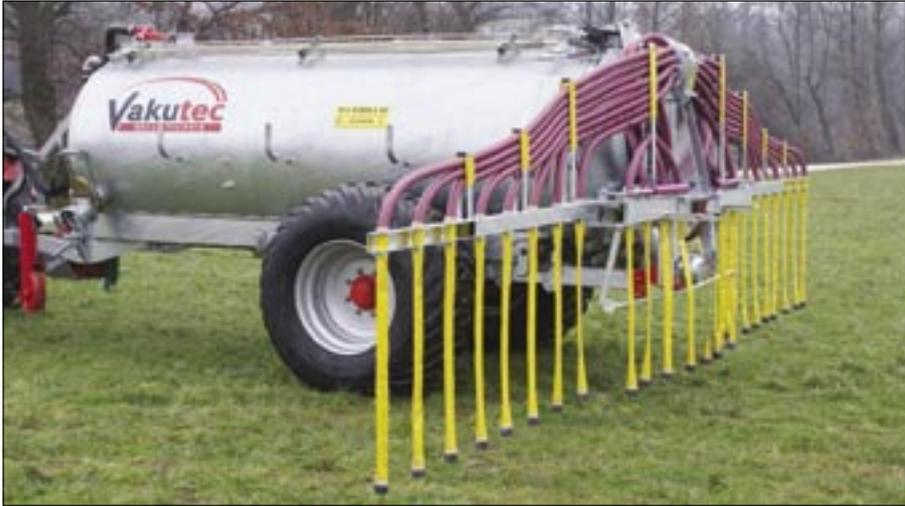
Wie der Name schon sagt, war das Ziel dieser Entwicklung eine standardisierte, voll funktionsfähige und dennoch preisgünstige Basismaschine, wodurch der kostengünstige Einstieg in die Verteilertechnik ermöglicht wird. Das Standardmodell überzeugt durch einfache Technik, eines geringen Eigengewichtes sowie eines sehr nahen Anbaus an alle Fasstypen, wodurch der Schwerpunkt möglichst weit vorne gehalten wird.
