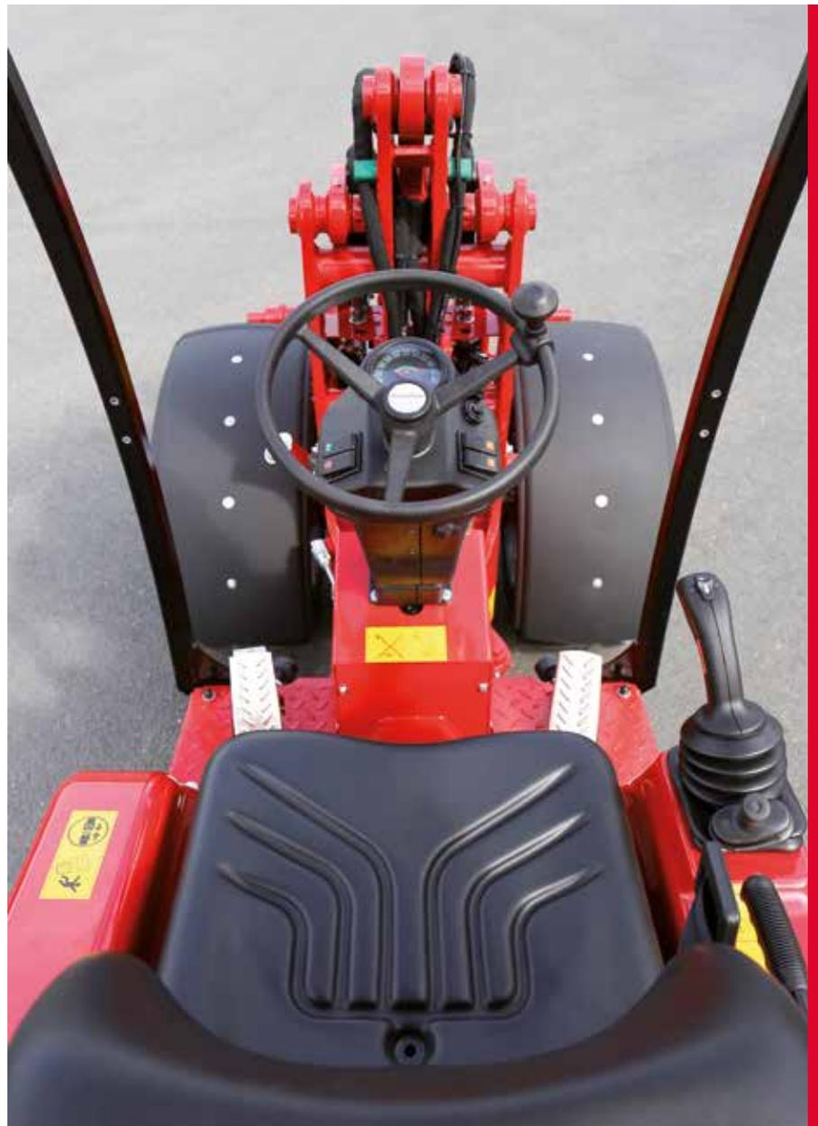
Auch die Ergonomie des Laders ist hervorragend. Der Fahrer hat trotz der sehr kompakten Maschinenabmessungen viel Platz. Er arbeitet durch die optimierte Positionierung von Joystick und Lenker noch bequemer.
