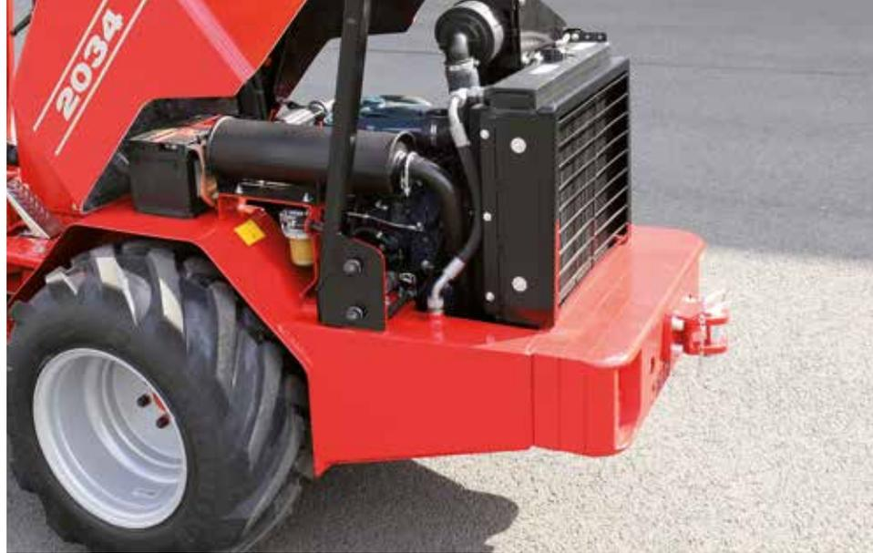
Die Motorhaube kann nach vorn geöffnet werden. Somit sind alle Servicestellen von beiden Maschinenseiten aus leicht zugänglich.
