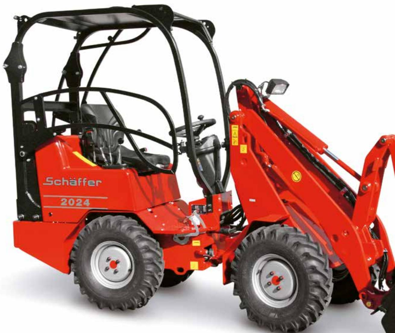
Mit der Schaffer Hofladeraufnahme SWH ist das Ankuppeln aller Arbeitsgeräte ein Kinderspiel. Das hydraulische Ver- und Entriegeln ist serienmäßig und sehr komfortabel. Original Schaffer Arbeitsgeräte sind mit dem Doppelhaken-Aufnahmerahmen ausgerüstet. So kann der Ein- und Auskippwinkel dem Ladegut problemlos angepasst werden. Bei Schüttgütern wie Getreide wird ein größerer Einkippwinkel, bei anderen Materialien ein größerer Auskippwinkel gewählt – einfach, flexibel, genial.
