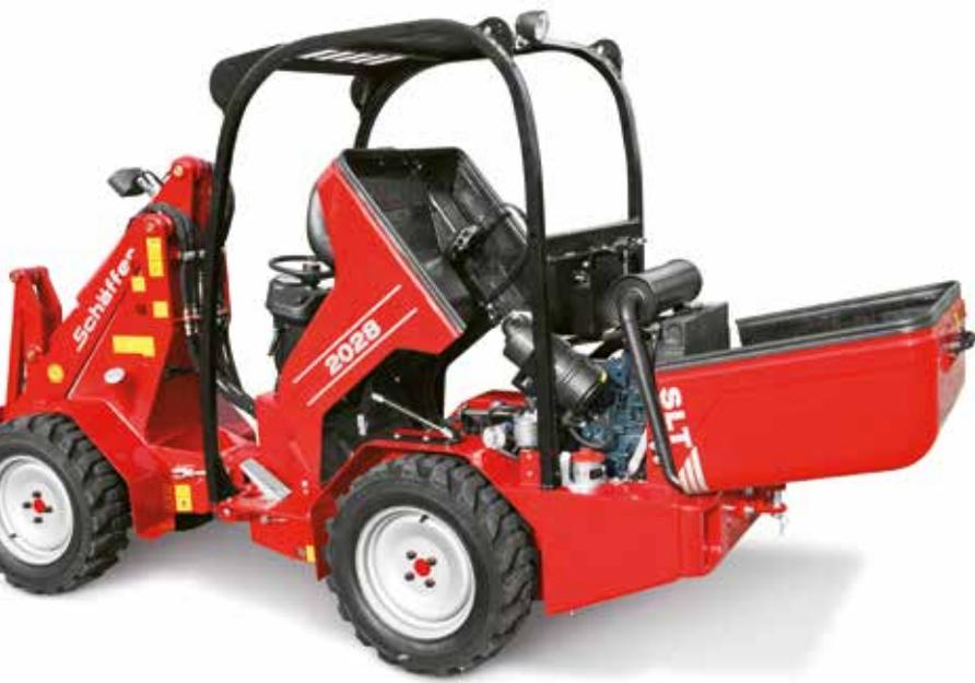
Die vordere und hintere Motorhaube lassen sich einfach öffnen. Wartungsarbeiten werden durch den leichten Zugang enorm erleichtert.
