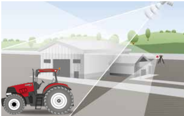
xFill überbrückt RTK-Signalausfälle von bis zu 20 Minuten
