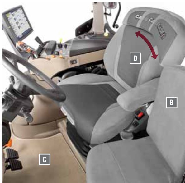
Der überragende Komfort des nur bei Case IH verfügbaren „Dual Motion“-Fahrersitzes mit Niederfrequenz-Federung, hoher Rückenlehne und wahlweise Textil- oder Lederbezug
