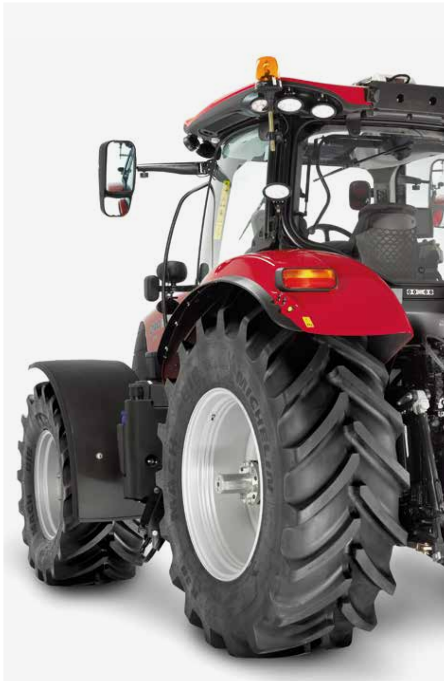
Multifunktional im Betrieb – mit bis zu 5 elektrischen Steuergeräten im Heck
