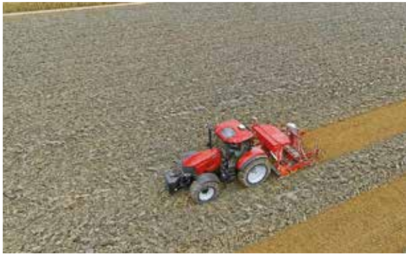
AFS Accuguide: GPS- und GLONASS-basierte Spurführung für ultimative Präzision unabhängig vom Zustand des Bestands. Mit RTK werden Genauigkeitsstufen von bis zu 2,5 cm erreicht.
