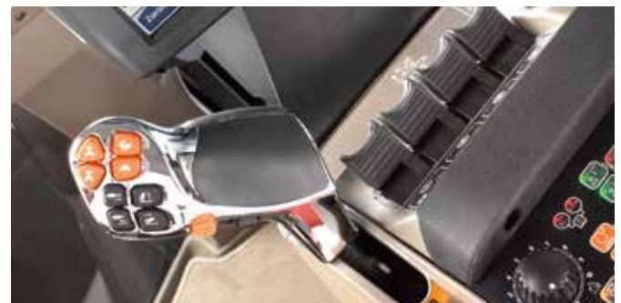
Der Multicontroller™ ermöglicht Gangwechsel ohne Betätigung der Kupplung
