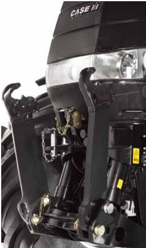
Vollständig integriertes Fronthubwerk mit einer Hubkraft von bis zu 3.785 kg
