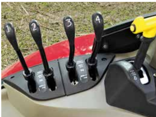
Je nach Modell sind bis zu vier mechanische Heck-Steuergeräte optional verfügbar
