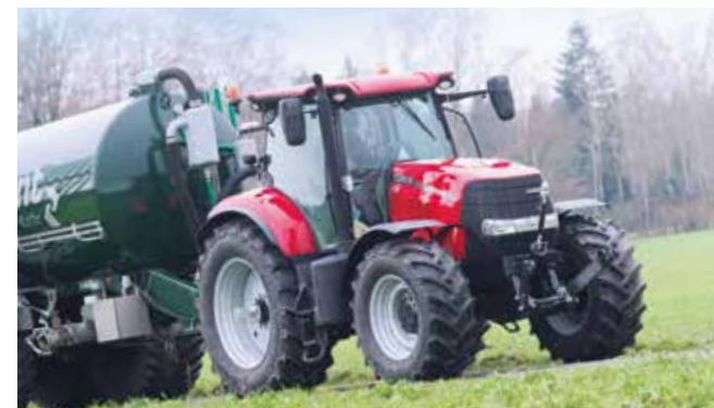
Die aktive Stillstandsregelung hält den Traktor auch in Steigungen ohne Betätigung der Bremse im Stillstand
