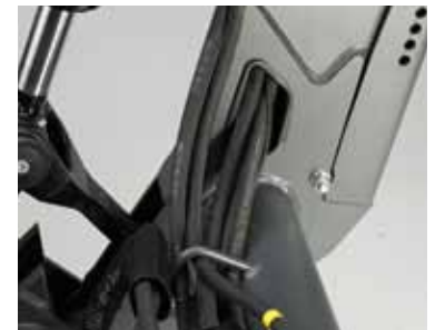
3 | SICHERE, GESCHÜTZTE SCHLAUCHFÜHRUNGEN IN UND AUF DER LADERSCHWINGE.
