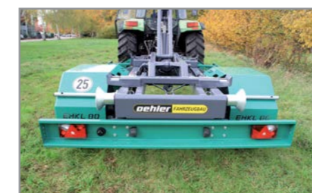
OL EHKL 80 Unterfahrerschutz mit Beleuchtungsanlage
