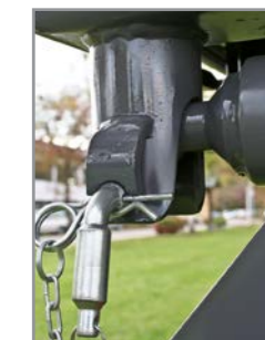
Kipplager mit Überkreuzstecksicherung
