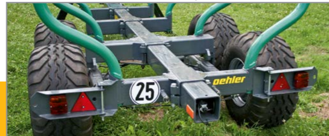
Einrohrrahmen mit verstellbaren Rungen
