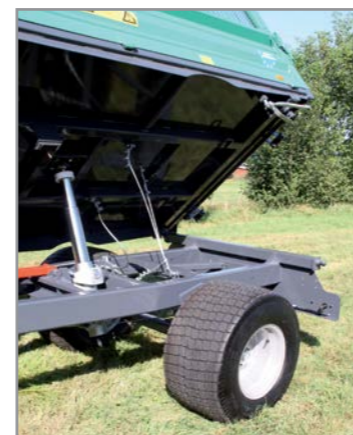
OL EDK 60 SB mit Bereifung R33x18LL-16.1 10PR TL Galaxy Turf
