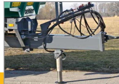
Gefederte Zugdeichsel – TDK 200
