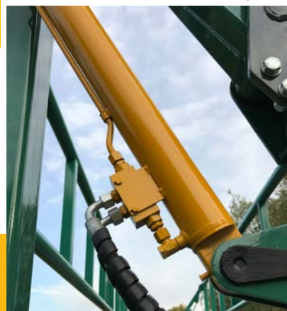
Mehr Sicherheit durch Rückschlagventil
