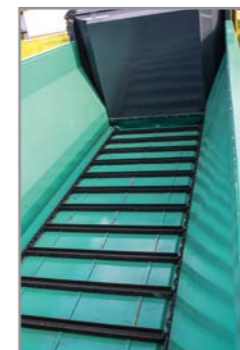
Stufenlose Kratzbodengeschwindigkeit (Vor- & Rücklauf)
