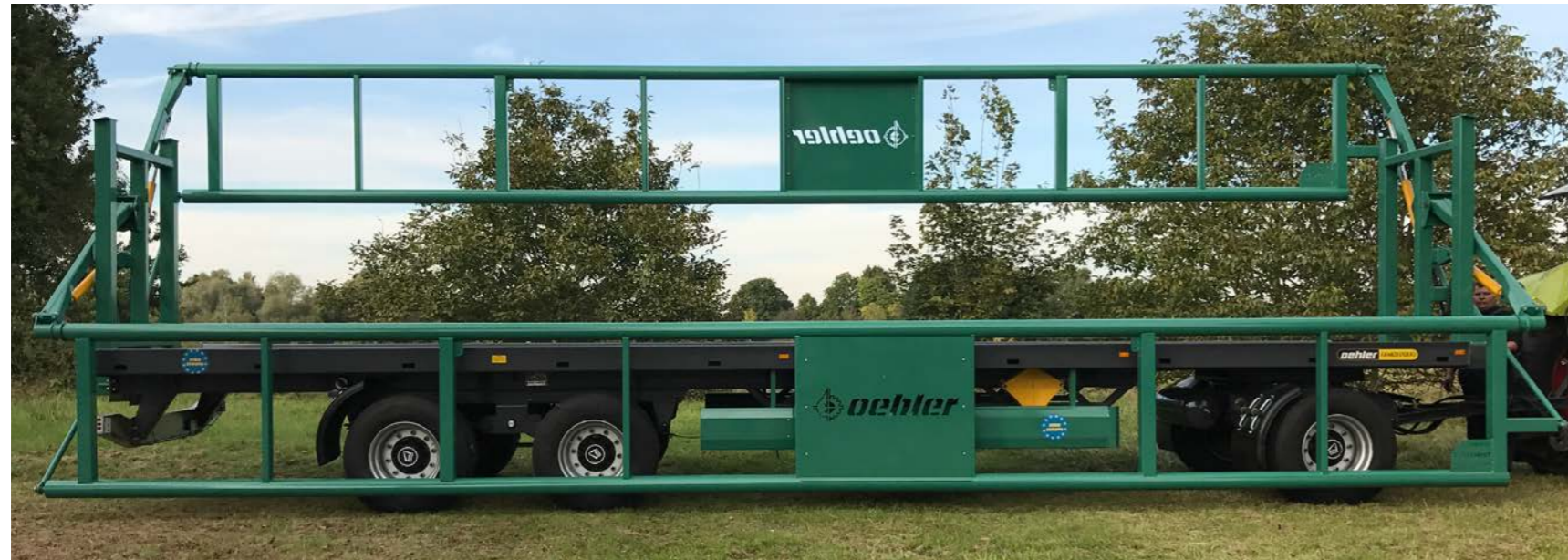
OL DDK 240 BK / Dreiachs-Ballenwagen mit Ladungssicherung System Krassort
