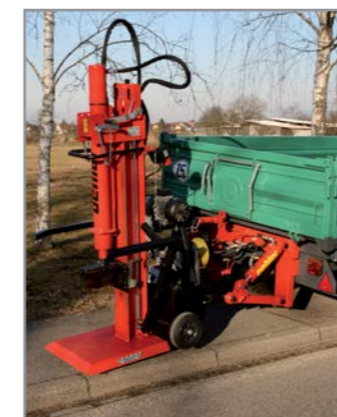
OL EDK 60 S mit Dreipunktaufbau und Zapfwellendurchtrieb mit Holzspalter OL 190
