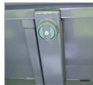
Robuste, eingeschweißte Rungenhalterung
