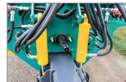
Hydraulisch gefederte Zugdeichsel
