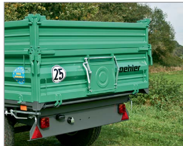
OL EDK 50 Zentralverriegelung hinten – Kornschieber und Unterfahrschutz
