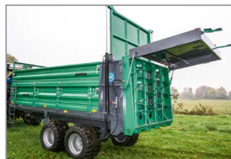
OL STT 80 mit Stauschieber + hydraulischem Streuschutz
