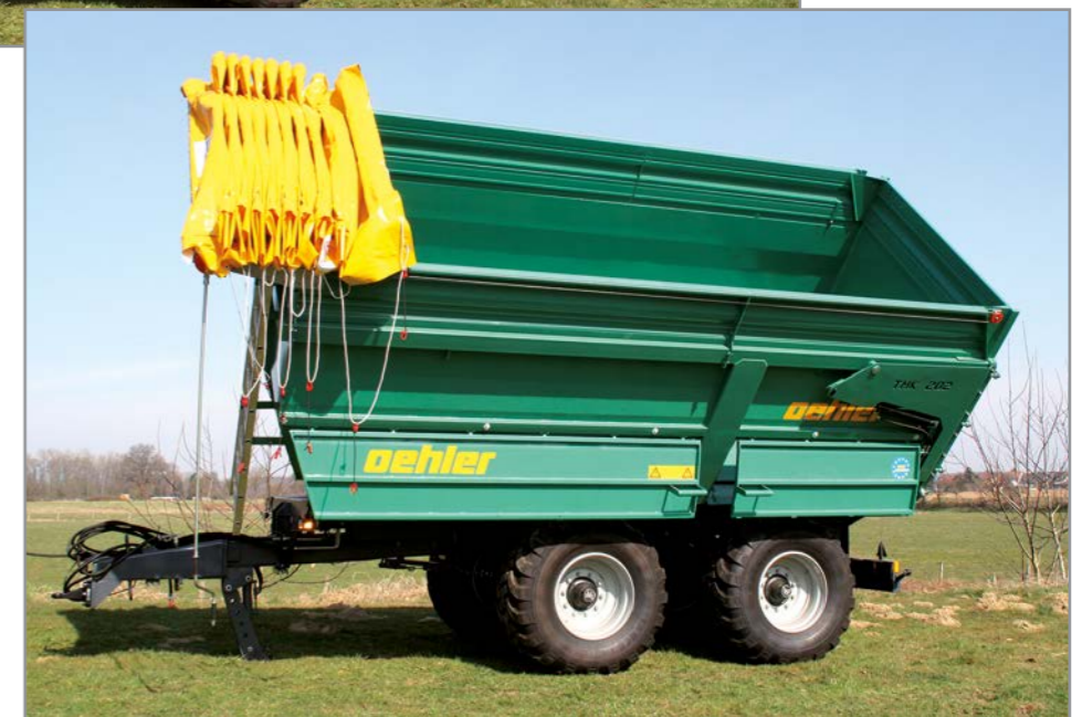
Schiebeplane mit Handkurbel bedienbar
