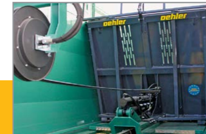
Schiebewand m. autom.Schlauchrolle
