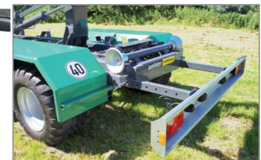
OL THKL 130 ausziehbarer Unterfahrerschutz
