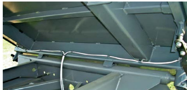
Zusätzl. Abtütz. der hinteren Kippwelle ab OL TKD 80
