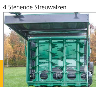
OL STT 80 mit Stauschieber + hydraulischem Streuschutz
