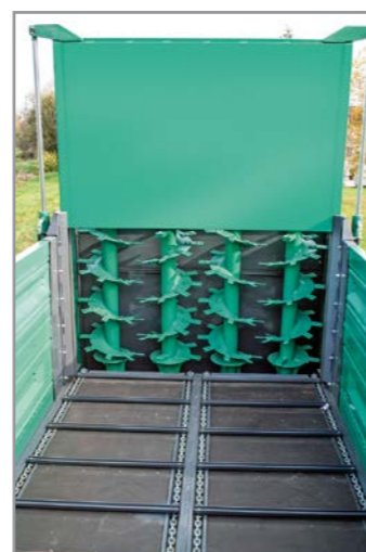
Kratzbodenleisten Hydraulischer Stauschieber
