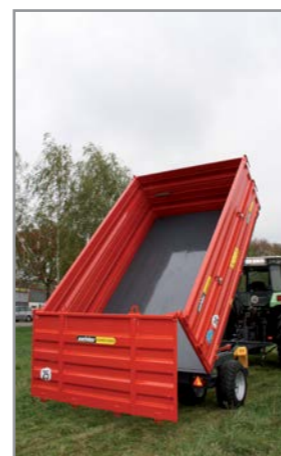
OL EDK 60 SG 1000mm pendelbare Rückwand
