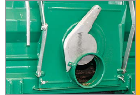
Kornschieber mit Feindosierung
