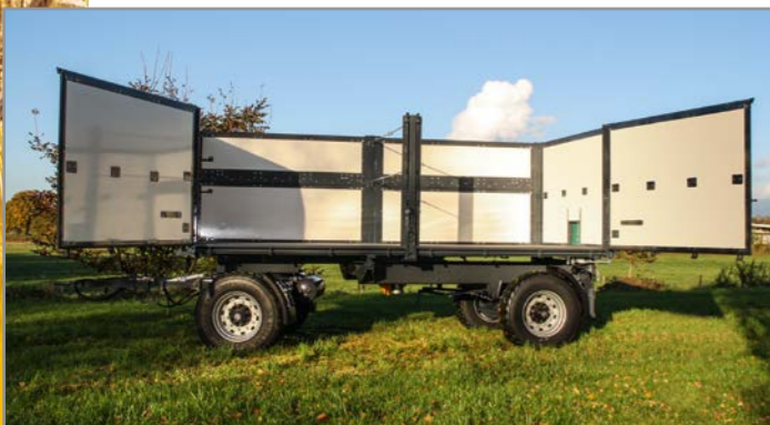
Seitenbordwände horizontal geteilt
