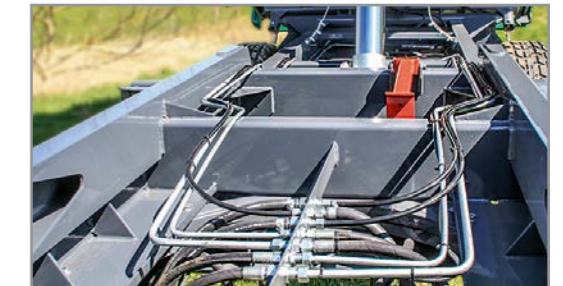
Öl- und Druckluftleitung nach hinten verlegt
