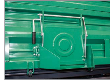
Kornschieber mit Kornschütte
