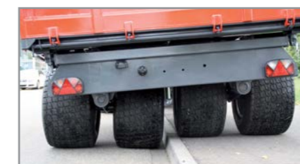
OL EDK 60 SG Höhenausgleich durch Pendelachse
