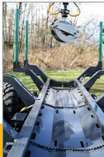
Kompakter stabiler Doppelrohrrahmen
