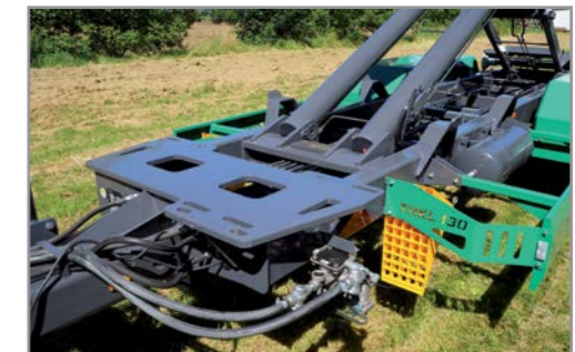
Anbauplatte für Kranaufbau
