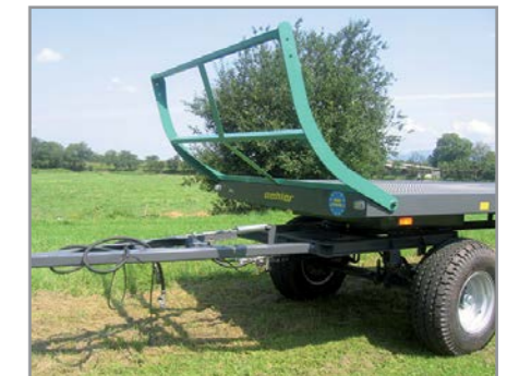
Bordwandgitter vorne und hinten klappbar
