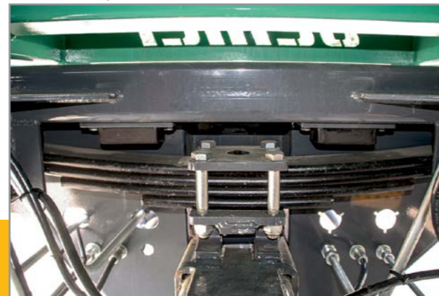
Gefederte Zugdeichsel bis max. 4 t Stützlast
