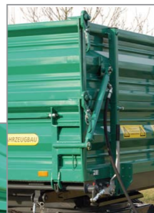
Hydraulische Schließung Bordwand Weinbau
