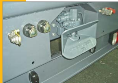
Anhängerkupplung mit Druckluft und 2. Ölanschluss
