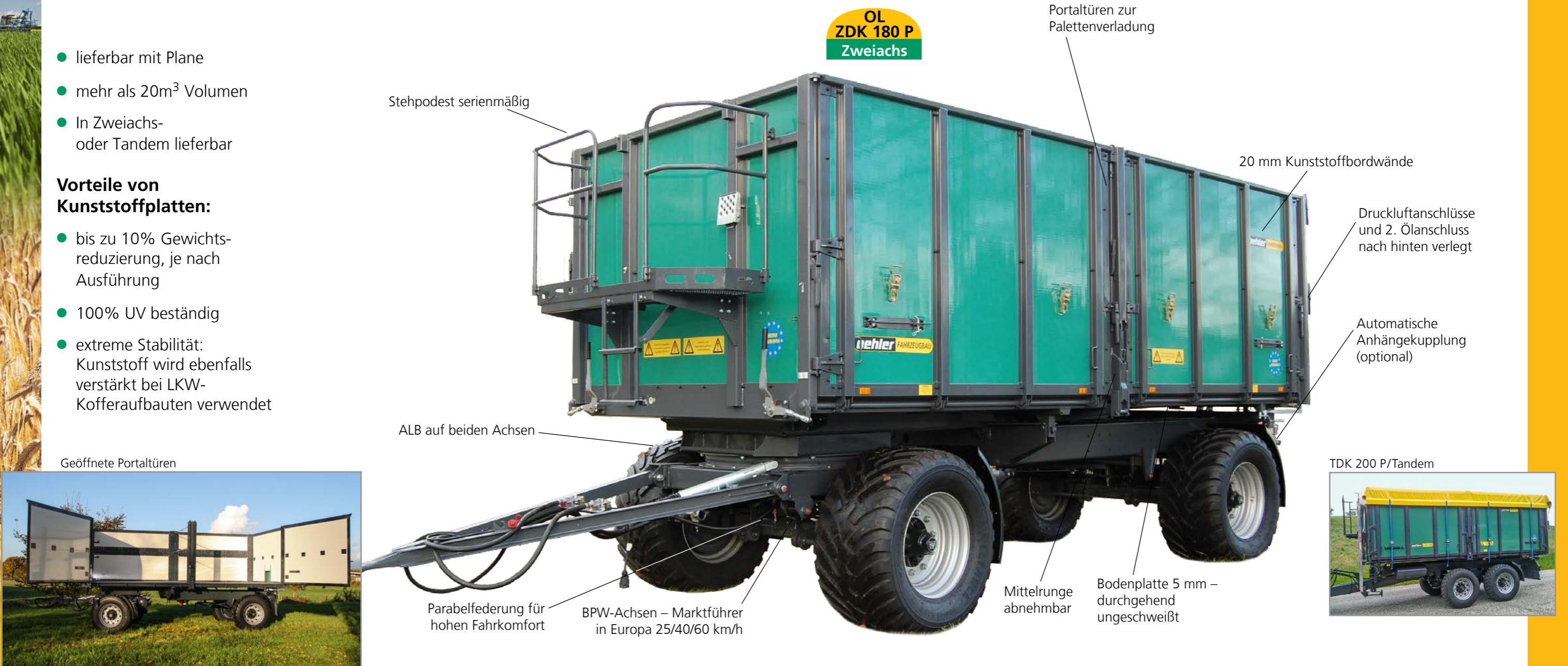
Seitenbordwände horizontal geteilt
