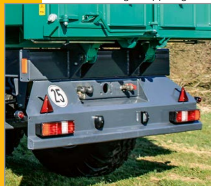
Unterfahrschutz mit automatischer Anhängerkupplung
