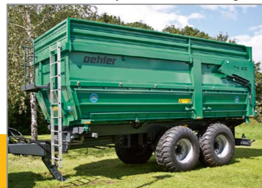
NEU Optional: seitlich kippbar mit hydraulischer Ver-/Entriegelung
