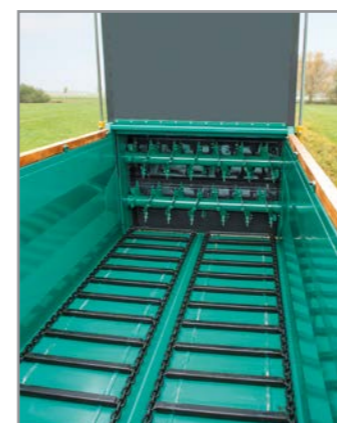
Kratzbodenleisten Hydraulischer Stauschieber
