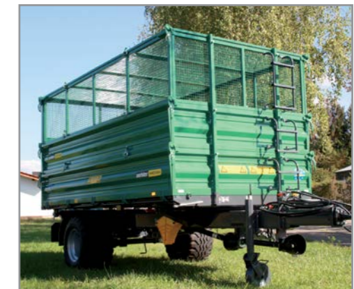
OL EDK 70 mit Laubaufsatz für Laubsauger
