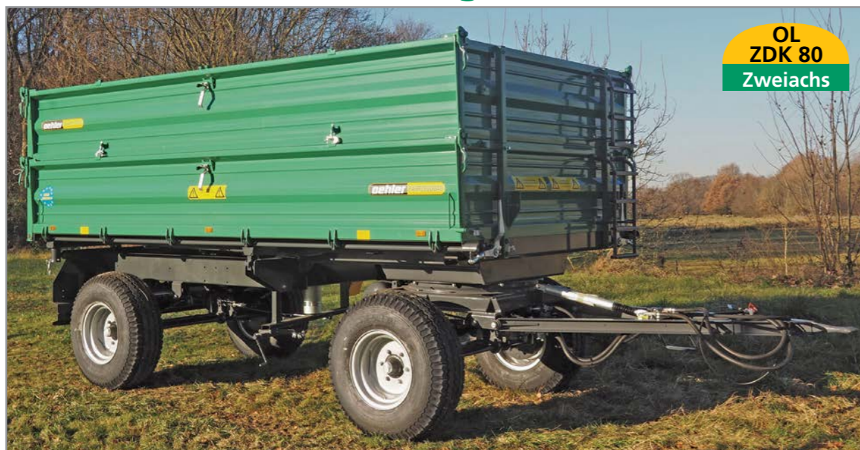
OL ZDK 80 mit Auflaufbremse und Aufsatz
