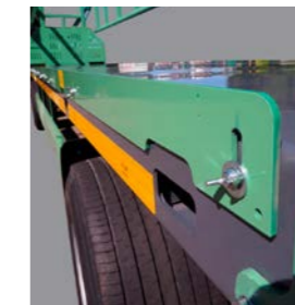
Verstellbare Sicherungsleiste für Großkistentransport
