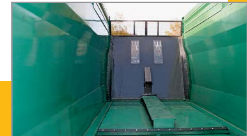
Schiebeboden auf verschleißarmen Kunststoff
