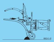
Das Trägerfahrzeug muss nicht angehalten werden. Bei leichteren Räumarbeiten oder bei Bedarf können ein oder zwei Rückzugfedern ausgehängt werden und das Schild gleitet leichter über ein Hindernis.
