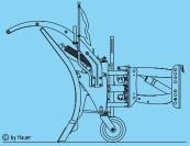
Bahn nach oben und nur leicht nach rückwärts aus. Bei einem größeren Hindernis weicht das Schild nach oben und vollständig nach rückwärts
