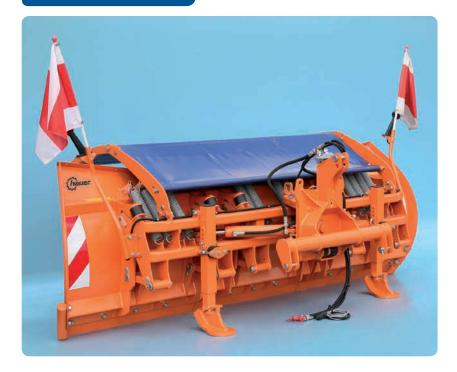
Beim SRS-3L mit 3-Punkt-Anbau ist die Vorbereitung für die hydraulische Dreheinrichtung, wie beim Kuppelplattenanbau, serienmäßig vorhanden.
