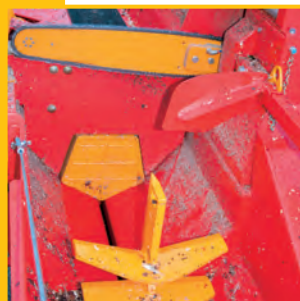
Harvesterketten-Schneideeinrichtung + 6-fach Spaltkreuz
