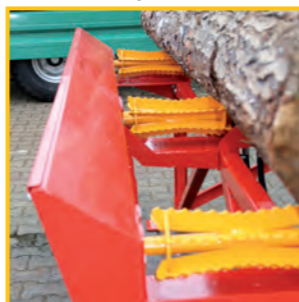
Holzlager mit 3 hydr. angetriebenen Rollen
