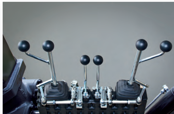
6-fach Steuerung mechanisch
