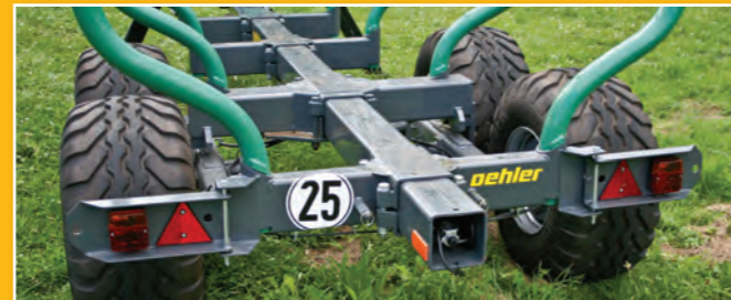
Einrohrrahmen mit verstellbaren Rungen
