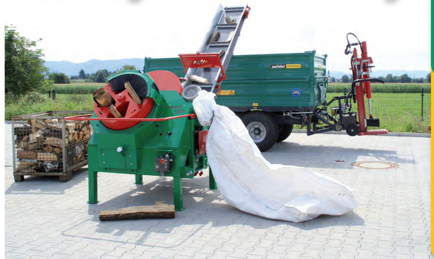
Höhenverstellbares Förderband, 2 fach teleskopierbar
