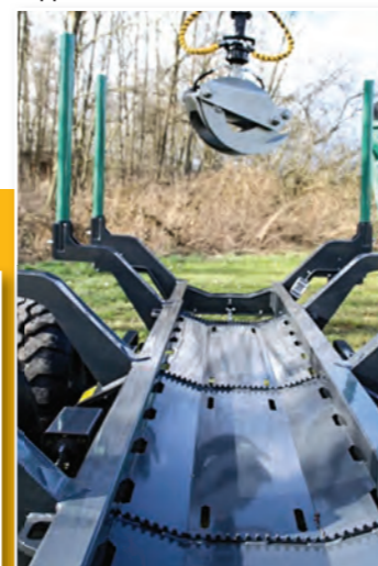
Kompakter stabiler Doppelrohrrahmen
