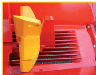
6-fach Spaltkreuz mit Reinigungseinrichtung
