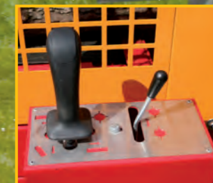
Joystick 4-fach hydraulisch
