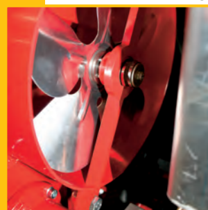
Lüfter für Ölkühlung
