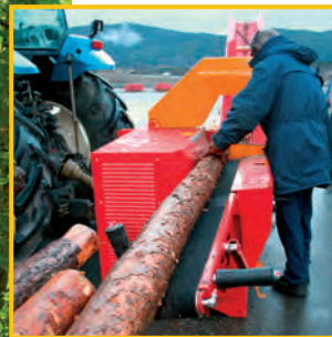
Verladeband mit Reinigungseinrichtung schwenkbar
