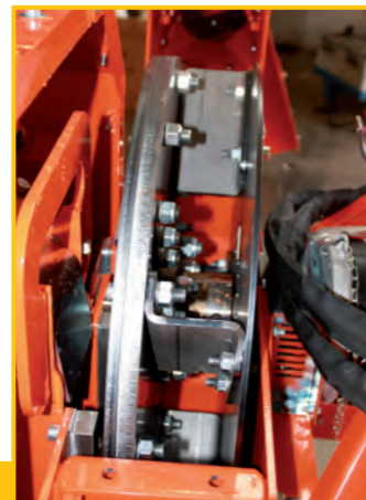
Messertrommel mit Auswurfseinheit
